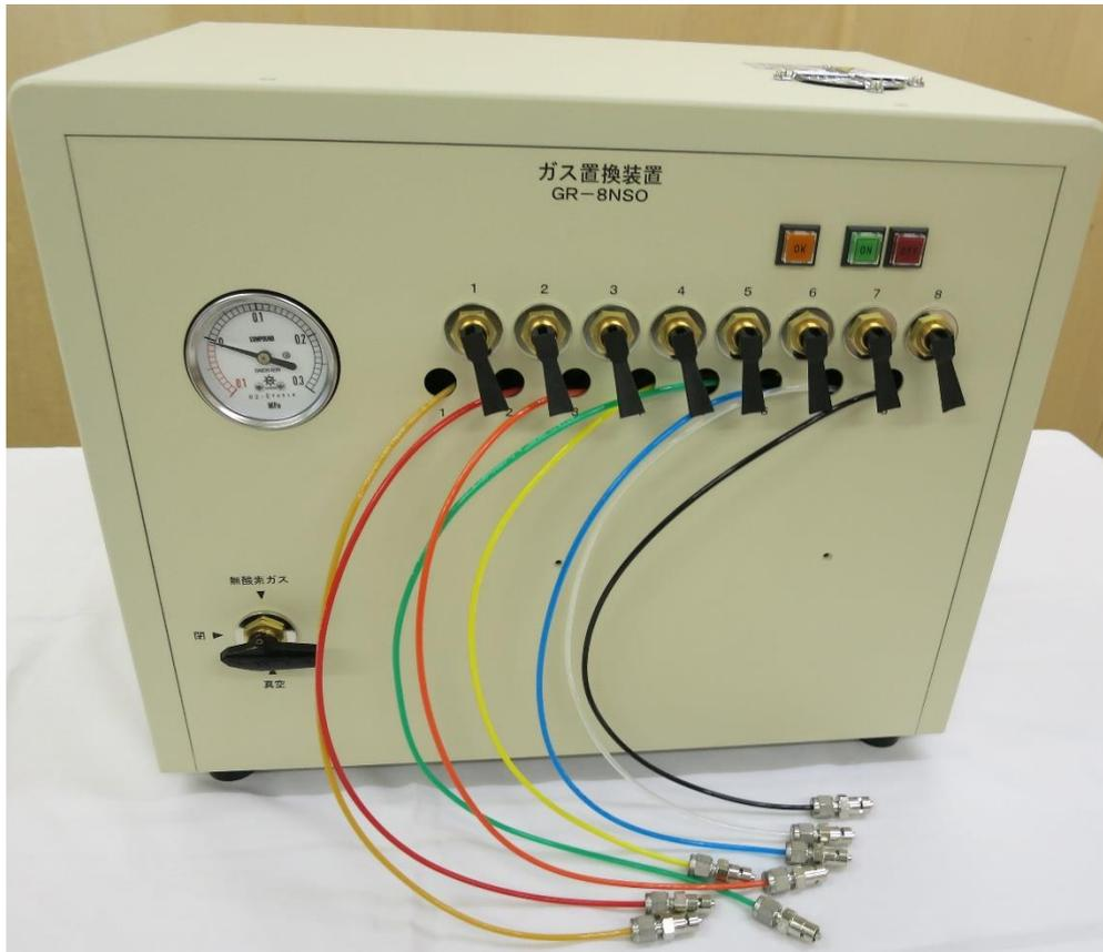
従来のガス噴射法による嫌気性菌培養装置では困難だったメタン菌等の培養が簡単にできる装置です。
